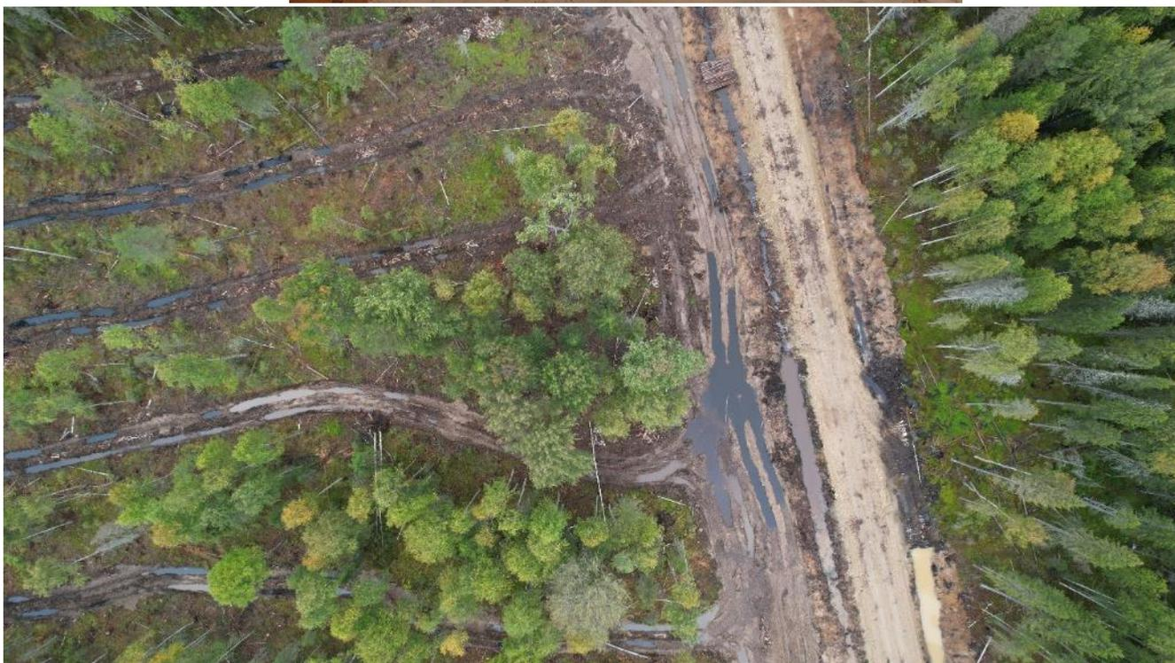
Рисунок 10. Перемешанный и смытый грунт погрузочной площадки (вверху) и канавы, выносящие воду с погрузочной площадки в водоток.
